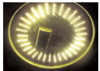
Moderne Lichtquelle: Die Lampen bestehen aus 160 LED, die in Gruppen zu je fünf strahlenförmig in einem Kühlring im Lampengehäuse sitzen.
