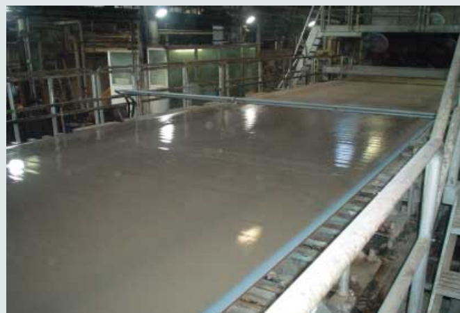
Pflanzliche Faserstoffe verbinden sich zu einem Vlies
